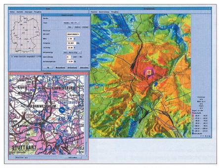
Bild 3 Arbeitsoberfläche von Kess bei Planung einer Punkt-zu-Punkt-Verbindung
