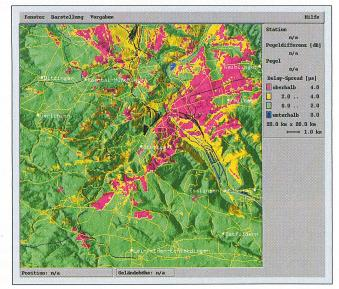
Bild 9 Flächenversorgung durch 5 Funkstellen
