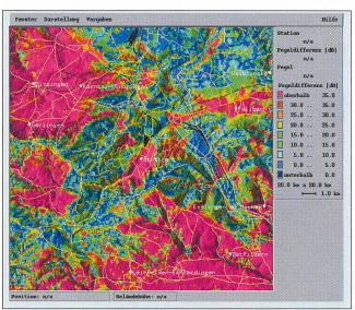
Bild 11 Geographische Verteilung des Nutzleistungs-zu-Interferenzleistungs-Verhältnisses bei 5 Funkstellen
