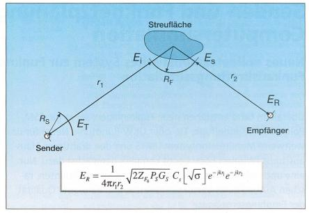
Bild 2 Bistatische Streuung zur Berechnung der Pfade bei Mehrwegeempfang
