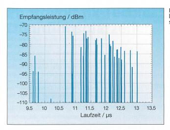
Bild 7 Empfangsleistungs-Verzögerungsspektrum
