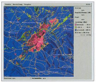
Bild 5 Geographische Verteilung der Empfangsleistung mit 2D-Ausbreitungsmodell
