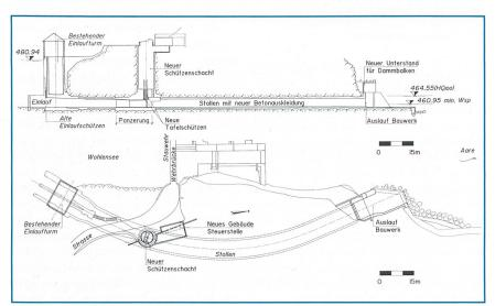
Bild 1 Grundablass Mühleberg: Situation (unten) und Längsschnitt (oben).
