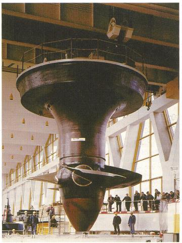
Bild 4 Modernisierung der Kaplanturbinen im Rheinkraftwerk Birsfelden (CH).
