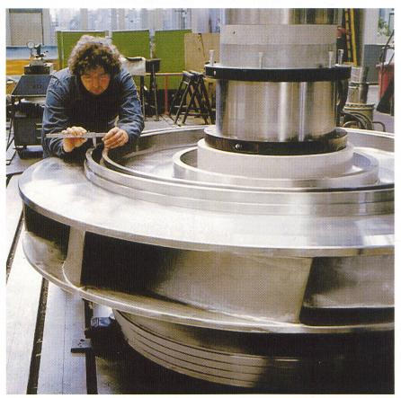
Bild 5 Pumpturbine für Anlage Xikou (China).
