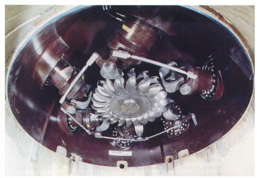
Bild 1 Compact-Peltonturbine für Anlage Dalpe (Schweiz).
