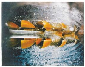
Titelbild: Dynamik der Wasserkraft. Dieses Peltonturbinenrad veranschaulicht die maximale Nutzung der Wasserkraft durch die Umleitung des Strahls in den Bechern um 180 Grad (Foto Sulzer Hydro).
