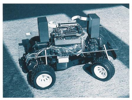
Bild 2 Der Pacificar mit Steuerelektronik
