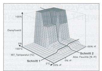
Bild 5 Kennfeld des Fuzzy-Controllers für das Dampfventil
