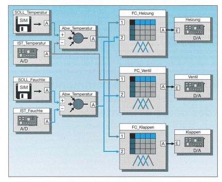
Bild 4 Struktur der Fuzzy-Controller
