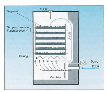
Bild 3 Schema des Trockners
