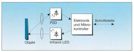
Bild 2 Grundstruktur des Distanzsensors
