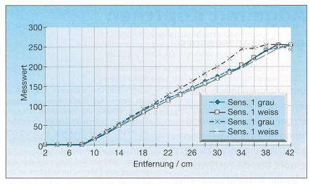
Bild 3 Messverhalten des Sensors im Bereich von 2 bis 45 cm
