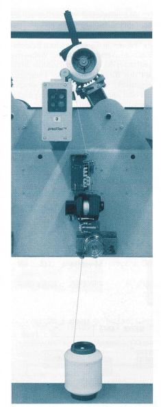
**Bild 1** Antriebskonzept mit Spindelmotor
