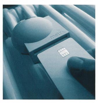
Bild 1 Einfaches Auslesen der Messgeräte mit Chipkarte (Foto: Bernina Flectronic)
