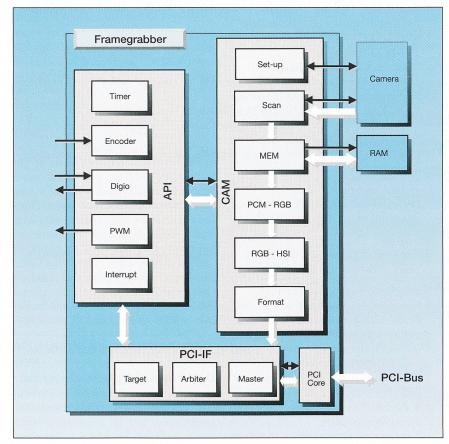
Bild 3 Blockschaltbild des Single-Chip-Framegrabbers
