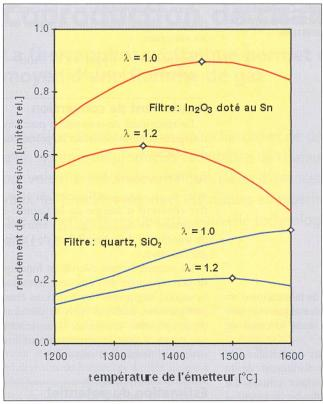
Fig. 4 Optimisation de la température de l'émetteur
