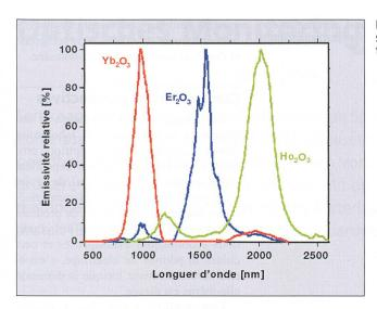
Fig. 2 Caractéristiques spectrales des oxydes de terres rares
