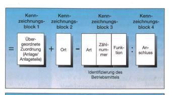
Bild 5 Kennzeichnung der elektrischen Betriebsmittel nach DIN 40 719, Teil 2
