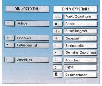
Bild 6 Gegenüberstellung der Normen DIN 40 719, Teil 1, und DIN V 6779, Teil 1, für die Kennzeichnung elektrischer Betriebsmittel
