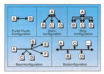
Bild 3 Die gebräuchlichen Verkabelungskonfigurationen (Topologien)
