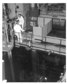
Untersuchung des Reaktordruckgefässes mit Ultraschall.
