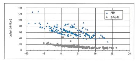
Bild 2 Vergleich der mittleren Wärmepumpenlaufzeit in Abhängigkeit der Aussentemperatur mit Pulsbreitenmodulation (PBM) und mit witterungsgeführter Zweipunkt-Rücklauftemperaturregelung für die ganze Messperiode (Winter 98/99; aus Schlussbericht).
