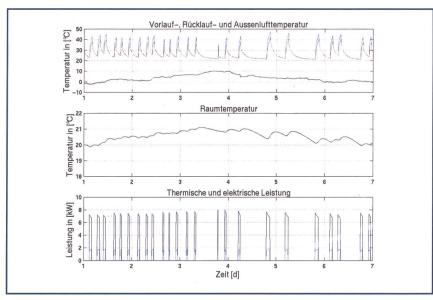
Bild 3 Simulationsresultate für die Woche 98-50 für das einfache Pulsbreitenmodulationskonzept (aus Schlussbericht).
