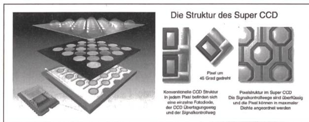
Hohe Pixeldichte durch wabenförmige Geometrie
