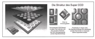
Hohe Pixeldichte durch wabenförmige Geometrie
