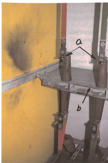
Bild 12 Schalterkontakte, an denen ein Erdschluss erzeugt wurde
