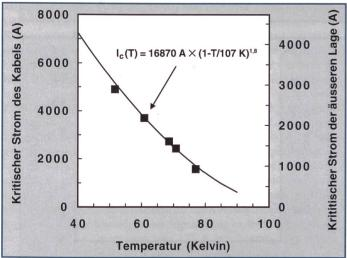
den maximal erreichbaren Strom im Kabel begrenzt. Ausgehend von den bei 77 K an Einzelbändern und der äusseren Lage des Kabels gemessenen Werten des kritischen Stroms kann auf eine Reduktion der Stromtragfähigkeit der Bi-2223-Bänder durch die Kabelherstellung von lediglich 14% geschlossen werden.
