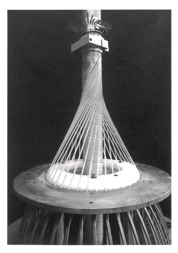
77 K ohne angelegtes Magnetfeld knapp 30 A. Bei diesem Leiter sind die supraleitenden Filamente von Reinsilber umgeben, während die Matrix ansonsten aus dispersionsgehärtetem Silber (AgMg) besteht. Für diesen Supraleiter liegt die maximal zulässige Biegedehnung bei 0,4%.
