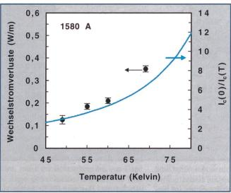
Bild 8 Temperaturabhängigkeit des Kehrwertes des kritischen Stroms des Kabels normiert auf  $I_c(0) = 16870 \text{ A}$ (blaue Linie) und der Verluste im Supraleiter (gefüllte Kreise) für einen Betriebsstrom von 1580 A Effektivwert. Die Wechselstromverluste sind etwa umgekehrt proportional zum kritischen Strom.
