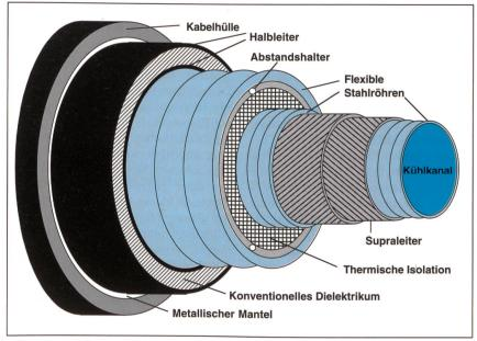
Bild 1 Schematische Darstellung einer einzelnen Phase eines supraleitenden Kabels mit warmem Dielektrikum.
