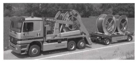
Bild 7 Geländegängiges Zugfahrzeug mit Auf- und Abwickelvorrichtung für Spulendurchmesser von 1650 bis 3400 mm (Kabeltransporte bis 12 t)
