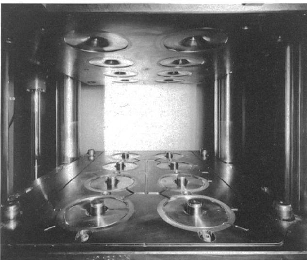
Bild 7 Spritzpresse mit Mehrfachform für die Isolatorschirme
