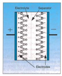
Fig. 2 Schéma d'un condensateur ECDL
