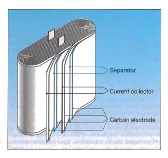
Fig. 3 Bobine de supercondensateur
