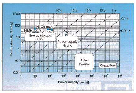
Fig. 1 Le graphique de Ragone représente la densité d'énergie en fonction de la densité de puissance des différents types de stockage d'énergie.
