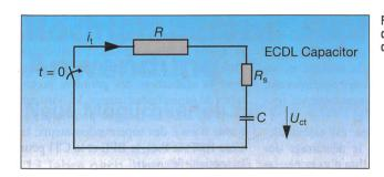
Fig. 5 Circuit de décharge d'un condensateur ECDL
