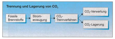
Bild 6 Verwendung fossiler Energieträger ohne CO<sub>2</sub>-Emissionen in die Atmosphäre
