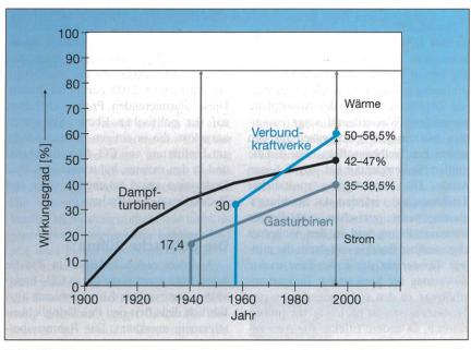
Bild 5 Historische Entwicklung des Wirkungsgrades verschiedener Kraftwerktechnologien
