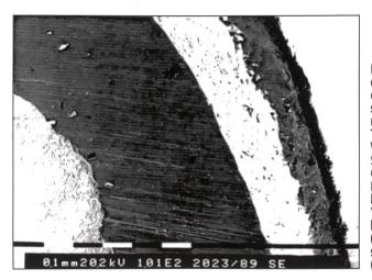
Bild 6 Querschnitt durch einen kontinuierlichen Sensor. Sichtbar sind von links unten nach rechts oben: Isolation, Trägerrohr mit 0,5 mm Wandstärke (rostfreier Stahl), plasmagespritzte **Grundschicht aus** NiCrAlY- und Yttrium-stabilisiertem Zirkonoxid YSZ (~200 μm), Supraleiter ~100 μm (YBa<sub>2</sub>Cu<sub>3</sub>O<sub>x</sub>) und Schutzschicht (~30 μm) aus PTFE (Teflon).
