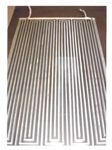
Bild 2 Thermisch gespritzte Alu-Heizleiter auf Glassubstrat als Heizplatte
