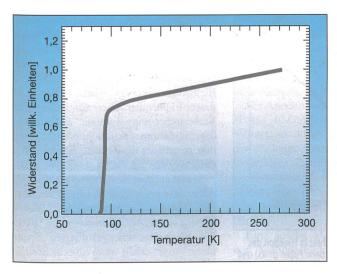
Bild 4 Widerstandsdiagramm in Funktion der Temperatur einer thermisch gespritzten YBa<sub>2</sub>Cu<sub>3</sub>O<sub>x</sub>-Schicht mit einer kritischen Übergangstemperatur  $T_c$ (onset) von 93 K und  $T_c$  (R = 0) von 89 K. Die dabei erreichten kritischen Stromdichten betrugen  $j_c$  (77 K) = 145  $A/cm^2$  und  $j_c$  (4,2 K) = 4500  $A/cm^2$ .
