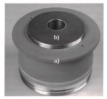
Bild 3 Thermisch gespritzte a) elektrische (Al<sub>2</sub>O<sub>3</sub>) und b) thermische (ZrO<sub>2</sub>) Isolationsbeschichtungen auf einem wassergekühlten Kupferbauteil für einen Hochtemperatureinsatz (Oberflächentemperatur < 2500 °C und Gleichspannungs-Isolation < 3500 V)
