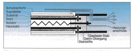
Bild 5 Ausschnitt vom schematischen Aufbau des thermisch gespritzten kontinuierlichen Sensors (Schichtdicken sind nicht massstäblich angegeben.)
