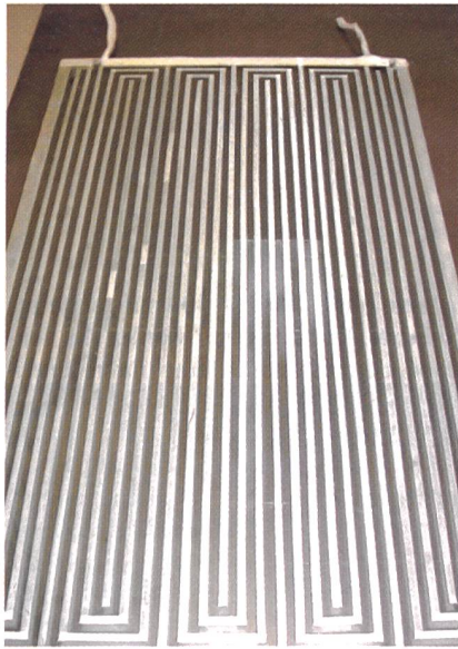
Bild 2 Thermisch gespritzte Alu-Heizleiter auf Glassubstrat als Heizplatte
