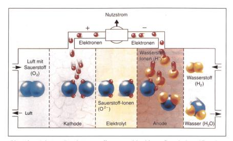
Bild 8 Schematische Darstellung des Wasserstoffumsatzes und des Elektronenflusses in einer oxidkeramischen Brennstoffzelle (SOFC) (Quelle: Spektrum der Wissenschaft [1995]7)
