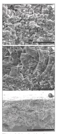
Bild 9 Detailaufnahmen thermisch gespritzter Schichten einer Hochtemperatur-Brennstoffzelle (SOFC). Aufgenommen mit einem Rasterelektronenmikroskop (REM)
