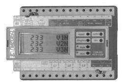
True RMS-4-Quadrantmessung – isolierte Messeingänge; mit/ohne Messdatenspeicher – mit/ohne THD-Anzeige; für Messungen in Niederund Mittelspannungsnetzen; Strom-/Spannungswandlerverhältnis ohne Einschränkung wählbar
