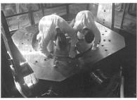
Les transports d'éléments combustibles usés provenant de centrales nucléaires suisses ont repris au début de septembre. On voit ici le nettoyage de la partie supérieure du conteneur de transport dans la CNG.
