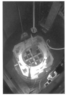
Der Transportbehälter wird mit abgebrannten Brennelementen beladen.
