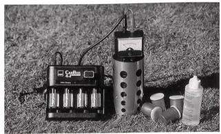
15-Watt-Brennstoffzelle zur Nachladung von Batterien mit integriertem Wasserstofferzeuger: Wasser plus «Stoff» ergibt Wasserstoff.
