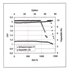
Bild 12 Lebensdauer einer 200-cm²-Zink-Luft-Zelle unter Dauerbelastung (9-h-Lade-Entladezyklen); Elektrolyt: 30% KOH (ZnO-gesättigt).
