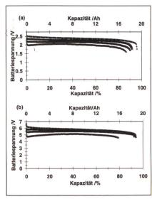
Bild 8 Entladekurven von 20-Ah-Zink/Luft-Batterien (C<sub>nom</sub> = 30 Ah). (a) zwei seriell geschaltete 20-Ah-Zellen; (b) fünf seriell geschaltete 20-Ah-Zellen. Entladegeschwindigkeiten: (+) C/25, (x) C/8.3, (▲) C/4.2, (♦) C/2.1.
