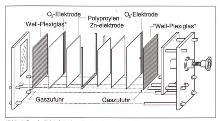
Bild 5 Aufbau der Zink-Luft-Testbatterie. Die Zellen werden modular bis zur gewünschten Endspannung (10 Zellen, rund 13,5 V, Luft) aufgebaut.
