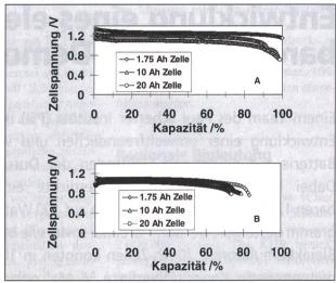
Bild 2 Entladekurven von 1,75 Ah (25 cm²), 10 Ah (100 cm²) und 20 Ah Zink/ $O_2$ -Zellen bei A) 24 h und B) 4 h Entladung.
