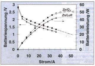
Bild 10 Strom-Spannungs- und Leistungskurven einer 20-Ah-Zn/O<sub>2</sub>- und Zn/Luft-Batterie (zwei Zellen in Serie).
