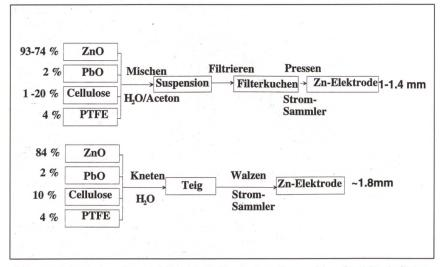
Bild 3 ZnO-Elektrodenherstellungsverfahren (oben); Filtrationsherstellungsverfahren für Elektrodenflächen bis 25 cm² (unten); Pastierverfahren für die industrielle Herstellung.
