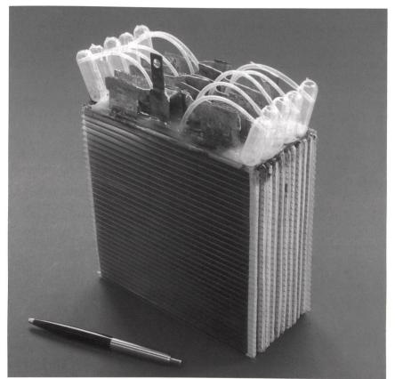
Demonstrationsmodul (12-V-Batterie ohne Gehäuse).
