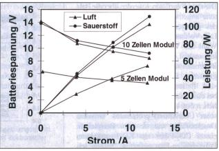
Bild 11 Strom-Spannungs- und Leistungskurven des 6-V/20-Ah-Zn/Luft- und 12-V/20-Ah-Zn/Luft- bzw. Zn/O<sub>2</sub>-Moduls.
