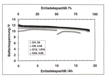
Bild 9 C/24-C/4 Entladungen des 12-V/ 20-Ah-Zink-Luft-Moduls.
