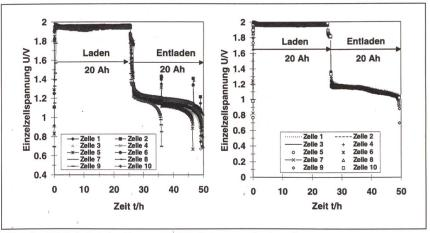
Bild 7a/b 25-h-Lade-Entladezyklus von 12-V/20-Ah-Demonstrationsbatterien.
