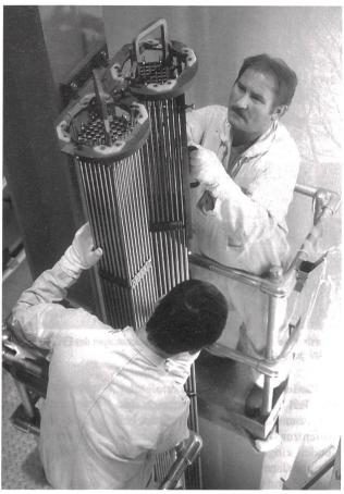
Kernkraftwerke: Erhöhung der Leistung (Brennelementbündel, Bild KKL).
