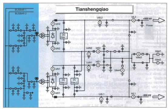
Bild 4 Single-Line-Diagramm der Station Tianshengqiao (Ausschnitt)
