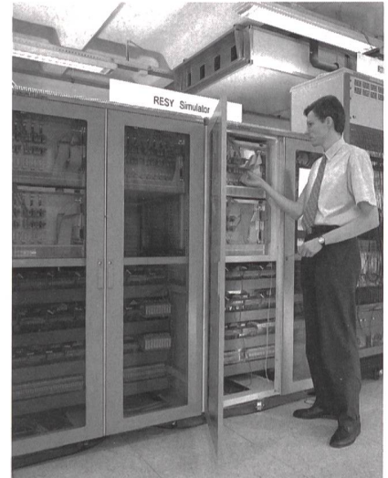
Bild 7 Aufbau der Echtzeitsimulatoren Resy und RTDS
