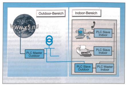
Bild 1 PLC im Outdoor- und im Indoor-Niederspannungsnetz
