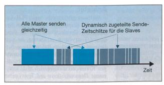
Bild 3 Synchronisierter Betrieb zur Unterdrückung von Übersprechen zwischen verschiedenen Strängen
