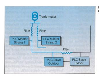
Bild 2 Filter zur Störungsunterdrückung
