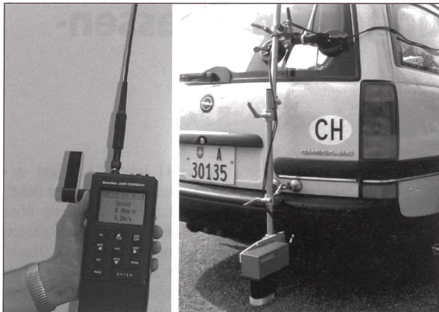
Bild 2 Die Eichung von Nachfahrtachographen, die bis anhin mit einem aufwendigen Messinstrument, einem optischen Korrelator (rechts im Bild), durchgeführt wurde, kann heute mit einem DGPS-Recorder (links) einfacher und kostengünstiger erledigt werden.
