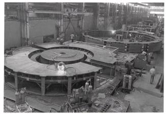
Hydrogeneratorenfertigung bei General Electric.
