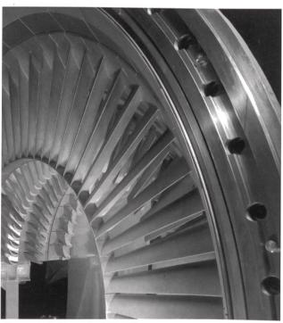
«Power»: Gasturbinenstator (Bild ABB).
