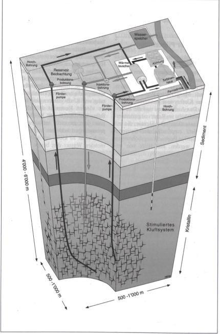
Das Prinzip eines DHM-Systems mit Wärme- und Stromerzeugung.
