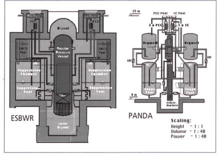
Bild 4 Die Versuchsanlage PANDA (rechts) bildet das passive Nachwärme-Abfuhrsystem einer Reaktoranlage (links) ab. Die Konfiguration für das ISP-42 entspricht dem European Simplified Boiling Water Reactor von General Electric (ESBWR).
