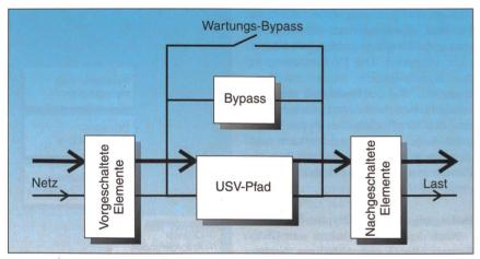
Bild 1 Lastfluss bei Betrieb über USV
