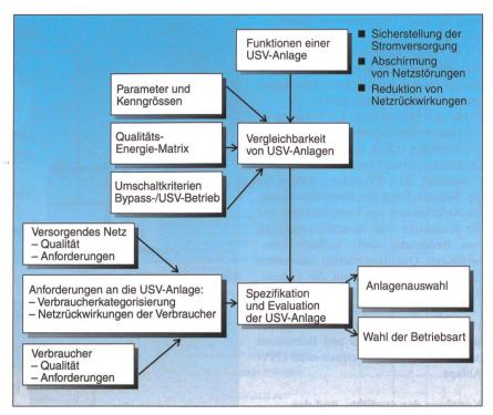
Bild 3 Spezifikation und Evaluation einer USV-Anlage
