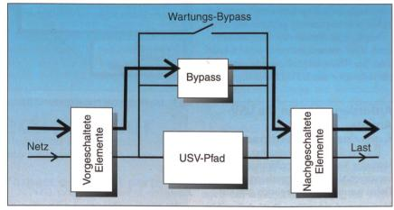
Bild 2 Lastfluss bei Betrieb über Bypass
