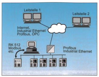
Bild 1 Kopplung von Systemen der Prozessautomatisierung
