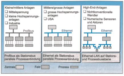
Bild 7 Mögliche Szenarien für die Schutz- und Stationsleittechnik
