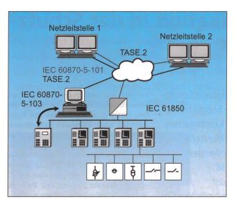
Bild 2 Kommunikationsstandards in der Energietechnik
