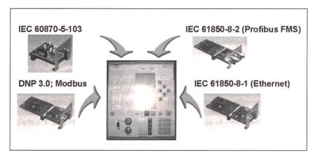
Bild 6 Flexible Kommunikation durch Interface-Modul-Konzept
