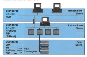
Bild 3 Positionierung von Bacnet im CEN-Ebenenmodell (Quelle BIG)
