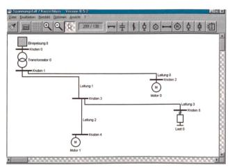
Bild 5 Kurzschlussfestigkeit/Spannungsabfall
