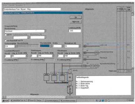
Bild 7 Eingabemaske für die Installationsanzeige
