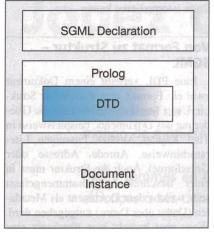
Bild 3 Komponenten eines SGML-Dokumentes
