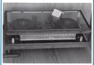
Stromwaage nach W. Thomson (Original 1887), AEG, Bj. 1934
