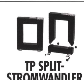
Die teilbaren Stromwandler sind die Problemlöser Nummer eins, sie minimieren die Kosten jeder Nachrüstung. Fünf Baugrössen decken Primärströme zwischen 100 bis 5000 Ampére. Die TP-Splitstromwandler von CIRCUTOR sind mit Sekundarströmen 5 oder 1 A und als Messumformer 4...20 mA oder 0...1,5 VDC lieferbar.
