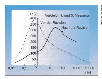
Bild 7 Resultate der Messung der Polarisationseffekte (Messung der Rückkehrspannung vor und nach der Revision)
