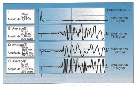
Bild 4 Lokalisierung einer TE-Quelle durch Messung der akustischen Wellen der TE-Quelle
