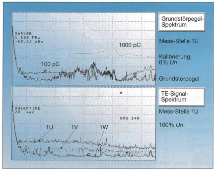
Bild 2 Frequenzspektren von Kalibrier- und TE-Signalen
