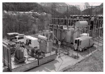
Bild 1 Versuchsaufbau für Teilentladungsmessungen
