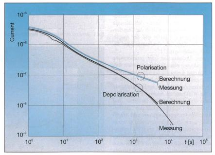
Bild 8 Resultate der Messung der Polarisationseffekte (Messung und Berechnung der Polarisations-/Depolarisations-Ströme)
