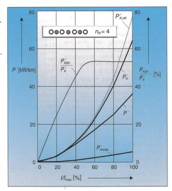
Bild 4 Hochspannungskabelanlage mit gebündelt im Kühlrohr verlegtem 110-kV-VPE-Kabel (1000-mm²-Kupferleiter). Weitere Erläuterungen im Text
