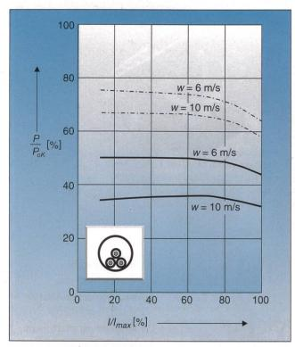
Bild 7 Verluste P' des Gesamtsystems bei Wärmerückgewinnung, bezogen auf die Verluste  $P'_{\text{oK}}$  des ungekühlten Kabels, als Funktion des bezogenen Laststroms ( $I_{\text{max}} = 1009$  A ohne Kühlung;  $P'_{\text{oK}} = 73,3$  kW), 110-kV-VPE-Kabel, Kupferleiterquerschnitt 1000 mm²; Verlegetiefe 1,5 m; Anordnung nach Bild 4
