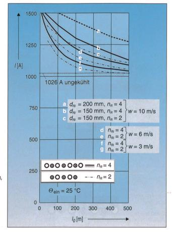
Bild 2 Kabelbelastbarkeit (110-kV-VPE-Kabel) als Funktion der Kühlabschnittslänge I<sub>0</sub>
