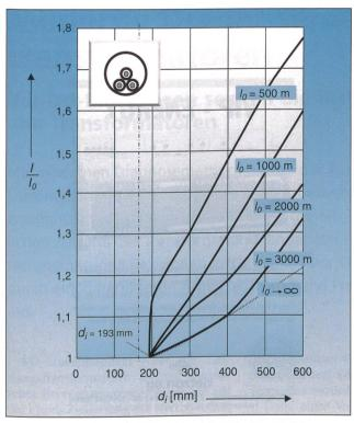
Bild 6 Kabelbelastbarkeit als Funktion des Rohrinnendurchmesers  $d_i$ , bezogen auf die Belastbarkeit des ungekühlten Kabels
