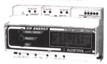
Energieanalysatoren VIP-Energy messen und registrieren genau: V, A, kW, kVar, kVA, cos-phi pro Phase + 3ph; Crestfaktor pro Phase; kWh, -kWh, kVarh, -kVarh pro Phase + 3ph; max. kW, max. kVA 3ph; Datum und Tageszeit. Strom- und Spannungswandler frei wählbar. Optionen mit RS485 Schnittstellen und Ausgangs-Impuls-Relais.
