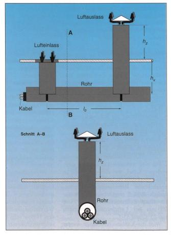
«Hot spot»-Problem erhöhter Muffentemperaturen gelöst wird, da sich die Muffen in diesem Fall immer in einem Kühlrohrbereich mit der niedrigen Lufteintrittstemperatur befinden und damit intensiver als die Kabeladern im Luftaustrittsbereich gekühlt werden.
