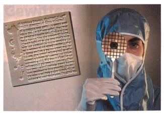
Cette réduction au dix millième d'un extrait de la Bible de Gutenberg illustre les possibilités du coulage par injection: L'empreinte en matière plastique occupe une surface à peu près de la taille d'une bactérie sur le disque compact.
