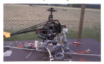
Autonomer Flugroboter für den Katastropheneinsatz
