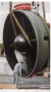
1 Eines von drei Peltonturbinenrädern (je 423 MW) im Kraftwerk Bieudron (System Cleuson-Dixence/VS). Das Inbetriebnahmeprogramm der Zentrale begann am 1. Oktober 1998.
