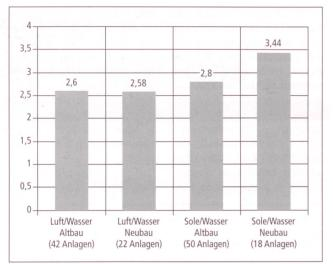
$\operatorname{Bild}$  3  $\,$  Jahresarbeitszahlen für Luft/Wasser- und Sole/Wasser-Wärmepumpen bei Alt- und Neubauten.
