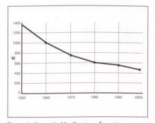
Figure 1 Pertes à vide d'un transformateur normalisé 400 kVA, 16/0,4 kV.
