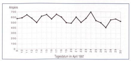
Bild 6 Maximaler Drainagestrom in Ampère: PEN - Minus Gleichrichter Schaffhauserplatz.
