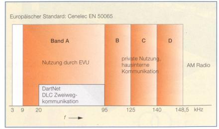
Bild 3 Frequenzbereiche für die Trägerfrequenzübertragung über Verteilnetze gemäss EN 50065.
