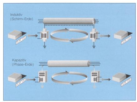
Bild 8 Prinzip der induktiven und kapazitiven Kopplung.
