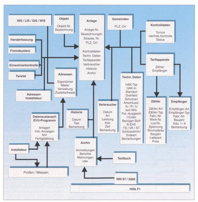
Bild 2 Datenstruktur in Easy Check 2.0
