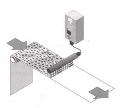
Statische Aufladungen führen in vielen Fertigungsprozessen zu Störungen. HAUG-Ionisationssysteme lösen dieses Problem bei der Folien- und Papierverarbeitung sowie in der Textil- und Kunststoffindustrie.
