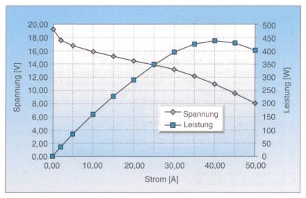
Bild 4 Stapel aus 20 Zellen mit Primea 5510
