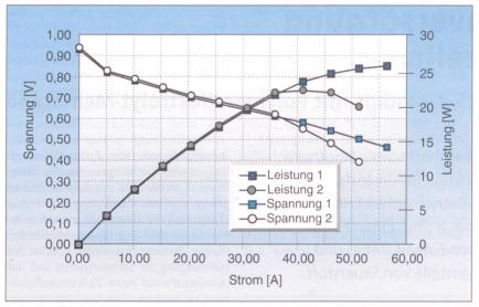
Bild 2 Zelle mit Primea 5510, H<sub>2</sub>/Luft-Betrieb
