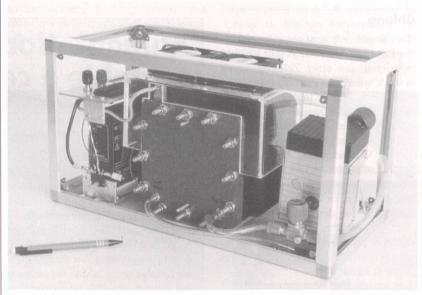
PEFC-Modul 300 W für H<sub>2</sub>/Luft-Betrieb
