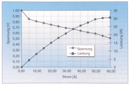
Bild 1 Kennlinien einer Brennstoffzelle mit Primea 5000 im H<sub>2</sub>/O<sub>2</sub>-Betrieb
