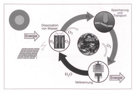
Bild 1 Wasserstoffkreislauf
