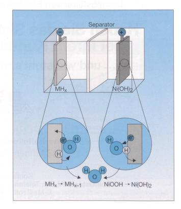
Bild 4 Schematische Darstellung einer Metallhydrid-Batterie
